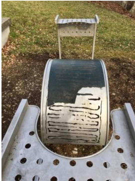
(Privat)Foto 1: Gummi löst sich auf, am Gerät zum Rückenstrecken im Oberhofer Weg, München.
