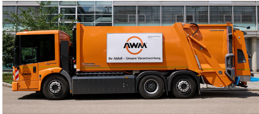
Unterwegs mit Wasserstoff: das neue Müllsammelfahrzeug des AWM. Foto: AWM
